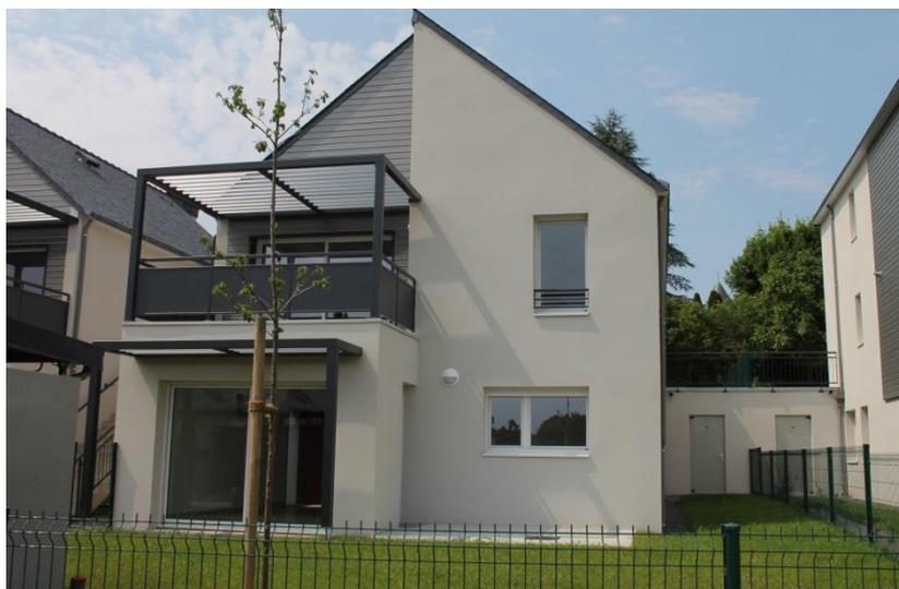
Les maisons sont des **logements de plain-pied**. Ce sont des volumes simples en maçonnerie, avec une toiture en ardoise à deux pans (pente de toiture à 40°) et un garage couvert en bac acier à très faible pente. Côté rue, un acrotère masque la toiture en bac acier.
